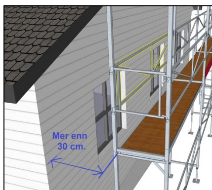
Rekkverk på innsiden når avstand er større enn 30 cm.
